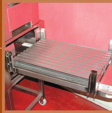
Il caricatore contiene una discreta quantità di padelle che dispone una alla volta dentro la grissinatrice.
