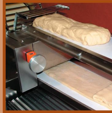
Un gruppo di cilindri di laminazione consente di ottenere un impasto con spessore adeguato ad ogni diametro di grissino che si vuole ottenere.
