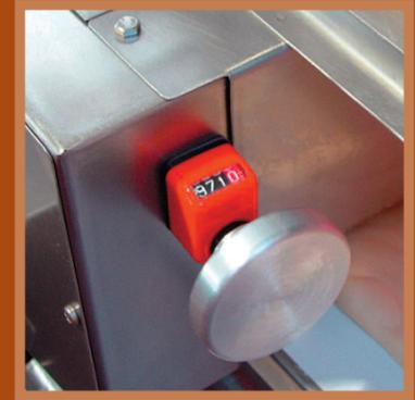
Lo spessore della pasta viene visualizzato tramite un indicatore numerico di facile lettura.
