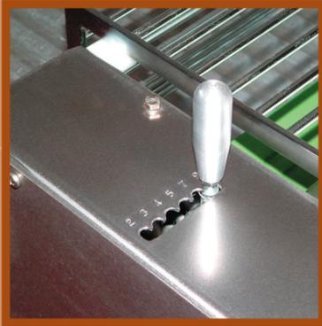
Il taglio dei grissini viene effettuato automaticamente: spostando la leva del selettore si ottiene la lunghezza desiderata.
